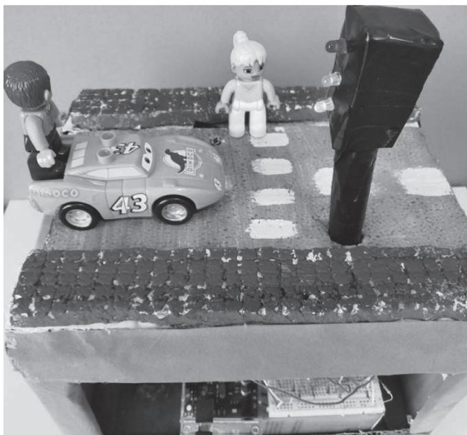
Fig. 12.1 Il semaforo con chiamata pedonale in 3D.
